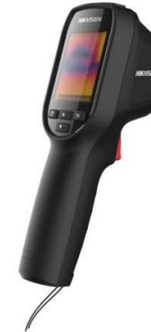
Ручной термограф DS-2TP31B-3AUF подходит для измерения температуры тела человека. Термограф оснащен тепловизионным модулем с разрешением 160 × 120. Позволяет быстро определить повышенную температуру тела.
